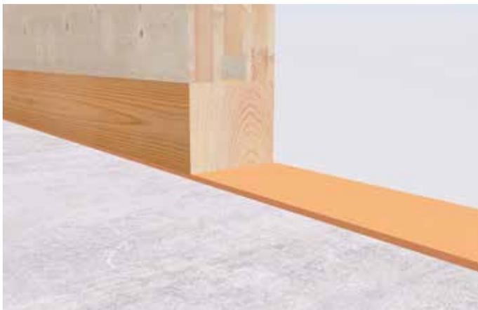
Mass-X<sup>®</sup> Calm zur Trennung und Schallisolierung von Fundament und Schwellenholz
