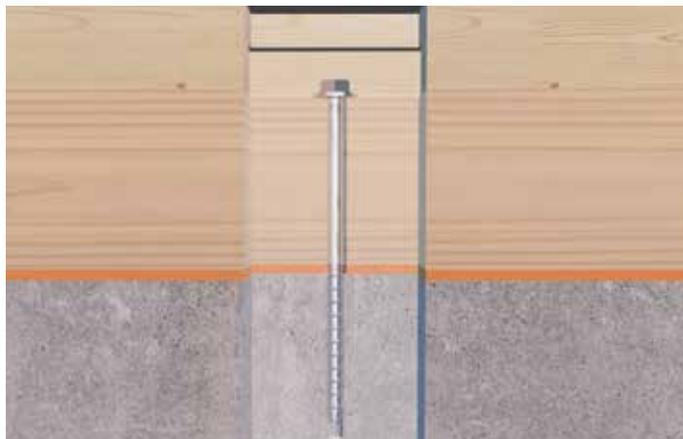
BeziFix® Anker ZSS/ZS eingelassen in Wand.
