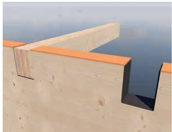
Mass-X ® Entkopplungsprofil unter Balken zur Schallsisolierung
