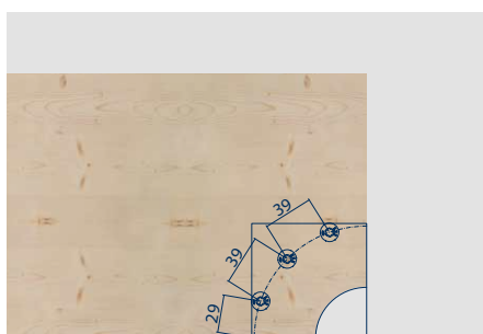
Auflager Kante: Schraubenanzahl 6
