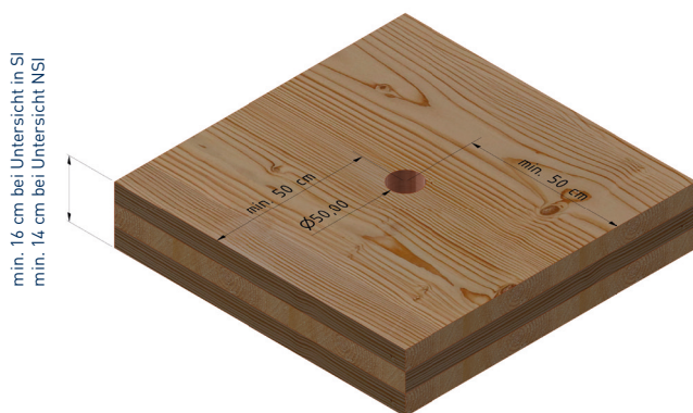
Horizontale Manipulation von BSP
