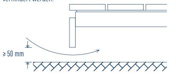
Bei einem seitlichen Abschluss der Terrasse durch ein Abdeckbrett ist eine Zuluft-Öffnung von ≥50 mm (durchlaufend) für die Belüftung der Terrassenkonstruktion einzuhalten. Das Abdeckbrett soll nicht den Boden berühren.
