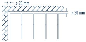
Beim Anschluss der Terrasse an angrenzende Bauteile ist ein Abstand von ≥20 mm einzuhalten, damit sich die Fugen weder durch Verschmutzungen noch durch Veränderungen der Dielen schließen können. Der ungehinderte Wasserablauf auf und unterhalb der Terrasse muss dauerhaft gewährleistet bleiben. Hierzu wird der Einsatz von Drainageroste (TerrassenFix Aqua®) empfohlen.
