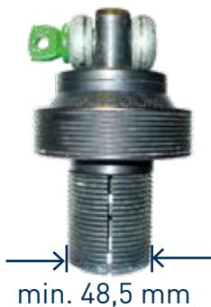
Der Durchmesser des Spreizelementes darf in zusammengedrücktem Zustand nicht weniger als 48,5 mm aufweisen
