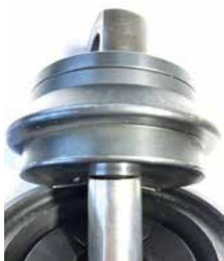
La barre d'attelage doit être fixée en haut avec la demi-boule, il ne doit en aucun être possible de tordre la demi-boule et la barre d'attelage
