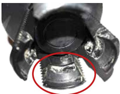
Die Gleitflächen von Spreizkeilen und Spreizkegel müssen eine einheitliche Oberfläche ohne fühlbare Riefen aufweisen. Verschmutzungen müssen wie bei Bild 1 entfernt werden
