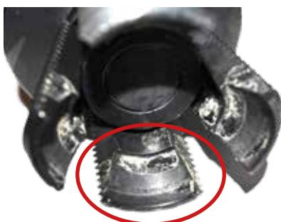
Les surfaces glissantes des coins et cônes d'écartement doivent être de qualité homogène sans arête au toucher. Les salissures doivent être éliminées comme sur l'illustration 1
