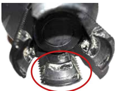
Wewnetrzne powierzchnie slizgowe, stozkowo-klinowa oraz element klinujacy urzadzenia musza byc jednolite i gladkie bez wyczulalnych zaglebien. Zanieczyszczenia usuwac wg. zalecen, zdj. nr. 1.
