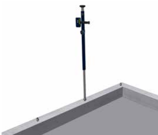
Wyrównanie poziomu za pomocą Orakelix®
