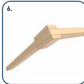
6. Nach dem Aufrichten des Trägers werden die restlichen Schrauben auf der Trägerseite eingebracht.
