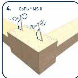
4. Der Träger wird aufgelegt und die zweite Lasche an der Stütze befestigt. Um einen Formschluss zwischen Träger und Stütze zu erreichen, wird eine GoFix MS II Schraube unter einer Neigung von 70° zur Lasche Richtung OK-Träger eingebracht. Diese Anordnung garantiert einen "Zusammenzieh-Effekt".
