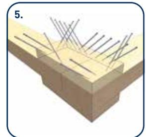
5. Die Bohrungen auf der Träger- und Stützseite der Laschen werden ausgeschraubt.
